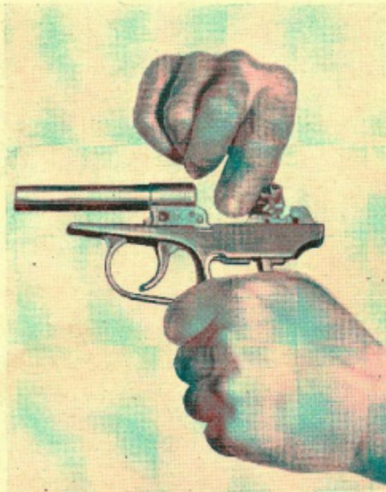
Abb. 31 Abzugsstange mit Unterbrecher herausnehmen
