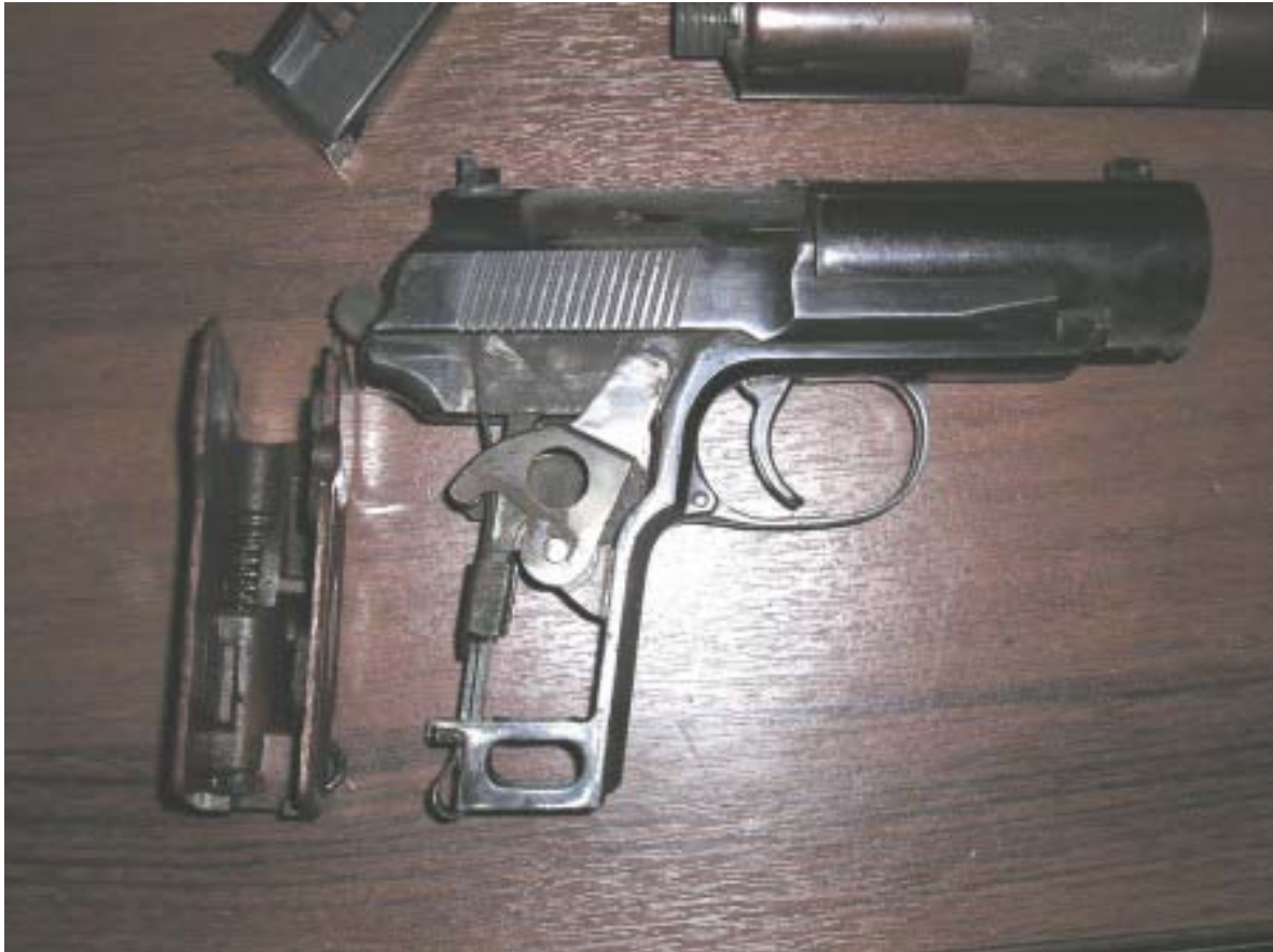
PB Pistole mit entfernter Griffschale, zeigt die Rückstellfeder im Inneren der Griffschalen und der Schwenkhebel, der die Rutsche und die Rückstellfeder verbindet
