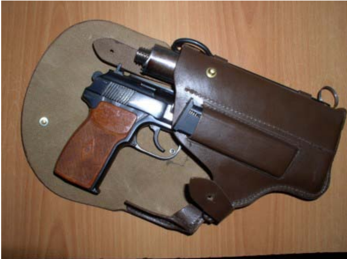
PB Pistole mit dem Holster in der Standard-Ausführung - Seitenfächer für Schalldämpfer und Ersatzmagazin
