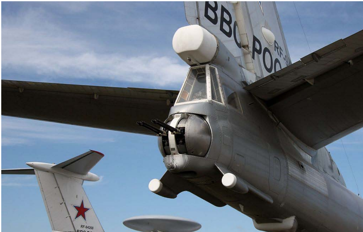
Die Am-23 ist ein Gasdrucklader im Kaliber 23 mm, der speziell für den Einsatz in Flugzeugen konstruiert wurde.
